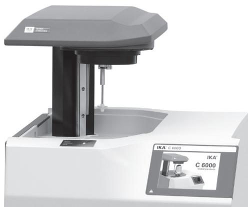
O calorímetro **IKA® C 6000 global standards/ isoperibol** é ligado no interruptor liga/desliga. A tampa abre automaticamente. Uma tela inicial é exibida durante aproximadamente 30 segundos, enquanto o hardware é inicializado e o software é carregado.
