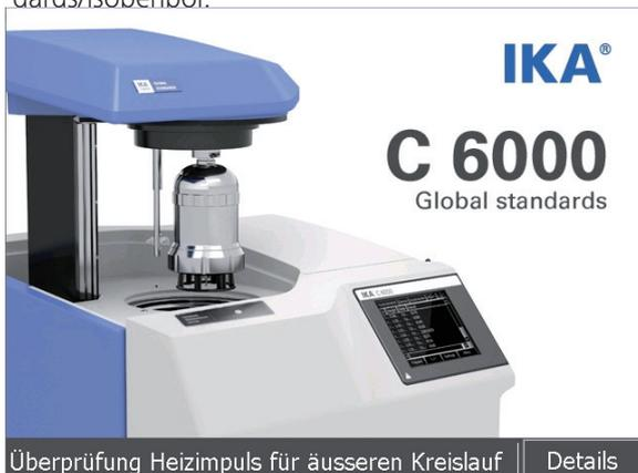
Durante a verificação de sistema, a tela inicial continua sendo exibida, um clique na tecla "Exibir detalhes" fornece informações detalhadas
