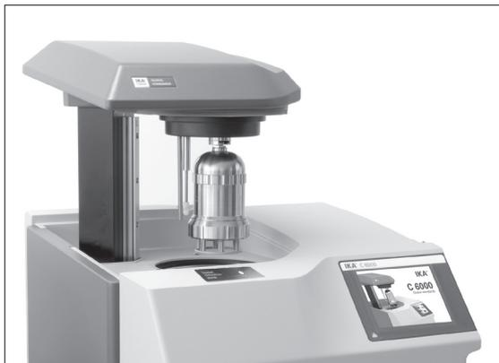
Depois de ser ligado, o display touchscreen do calorímetro IKA® C 6000 global standards/sooperibol torna-se ativo e pode ser operado com a caneta ou com o dedo.
