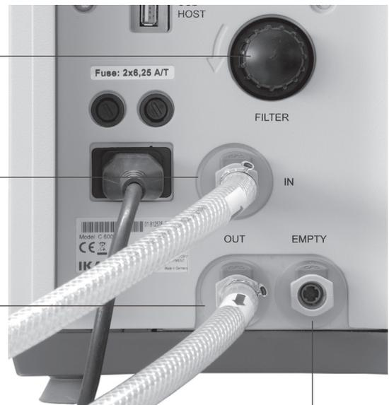
A conexão "VAZIO" serve apenas para esvaziar o aparelho, p.ex. para fins de transporte. Durante o funcionamento normal, o tubo de saída não deve estar encaixado!
